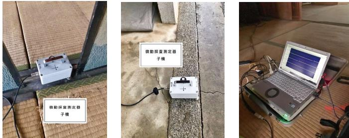
建物の2階と外に微小な振動を検知できる機械を設置して、それぞれの振動を測りその差を比べて耐震性能を測る。途中もう一回測り最後に3回目を測って耐震性能を確認する。
